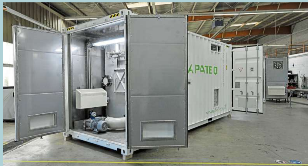
Die Wasseraufbereitungsanlage passt in einen Container
